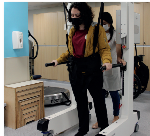
Andago: sistema robótico que acompanha a intenção de movimento do paciente, auxiliando na reabilitação motora
